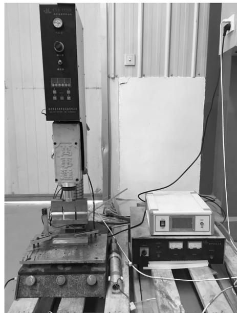
图 3 超声波焊接设备
