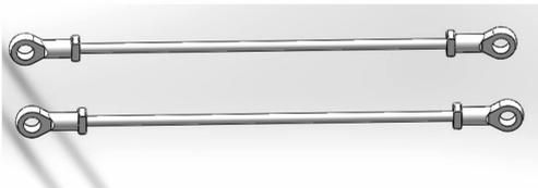
图4 并联臂结构图
