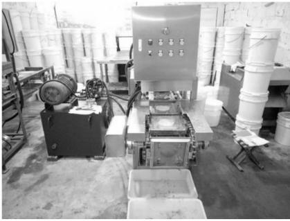
图11 碗形海蜇皮自动切丝机样机
