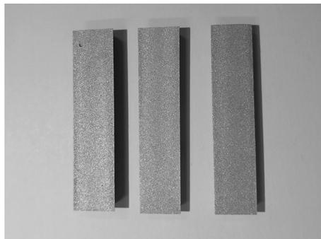
图 10 优化工艺参数下铸件试棒的轴向剖视图
