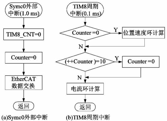
图 7 伺服系统中断程序流程
