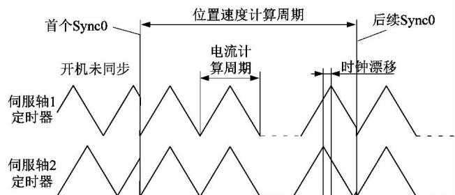
图 6 伺服轴定时器同步示意
