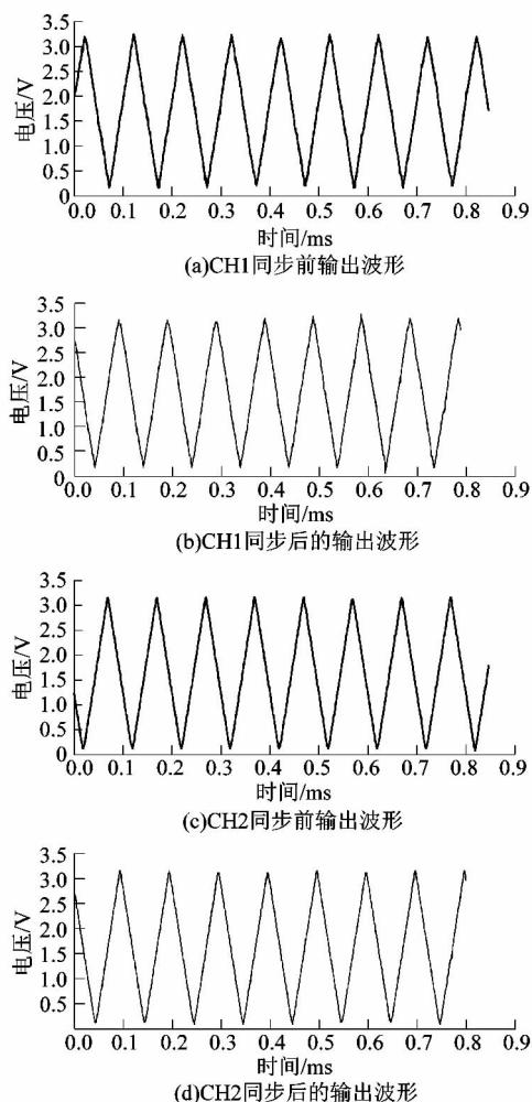
图 10 两系统的 DAC 输出波形
