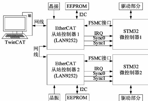
图 4 EtherCAT 硬件系统框图
