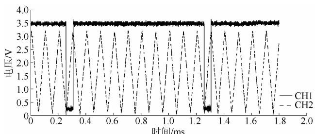
图 11 系统的 DAC 输出与 Sync0 信号波形图
