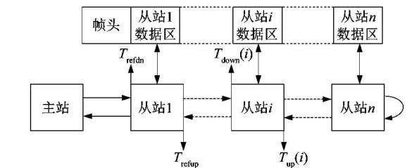
图 1 EtherCAT 通信原理
