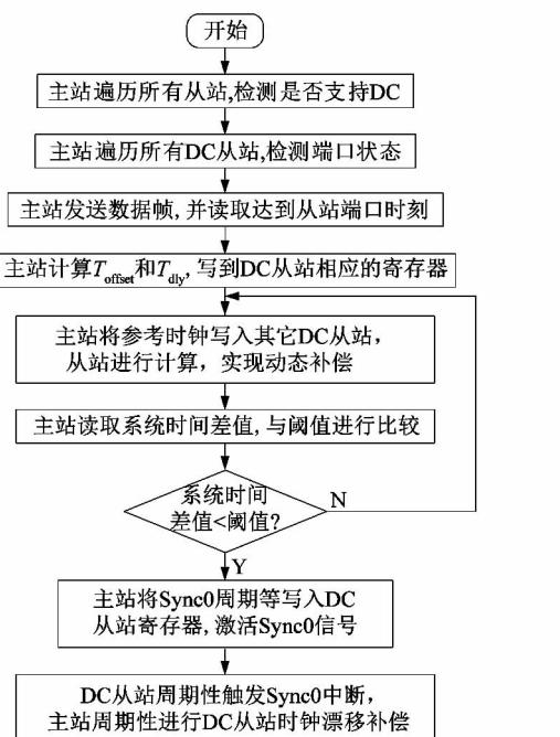
图 3 EtherCAT 分布时钟实现流程图
