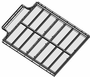
图 1 动力电池箱三维模型
