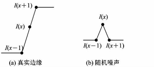
图3 真实边缘与随机噪声示意图
