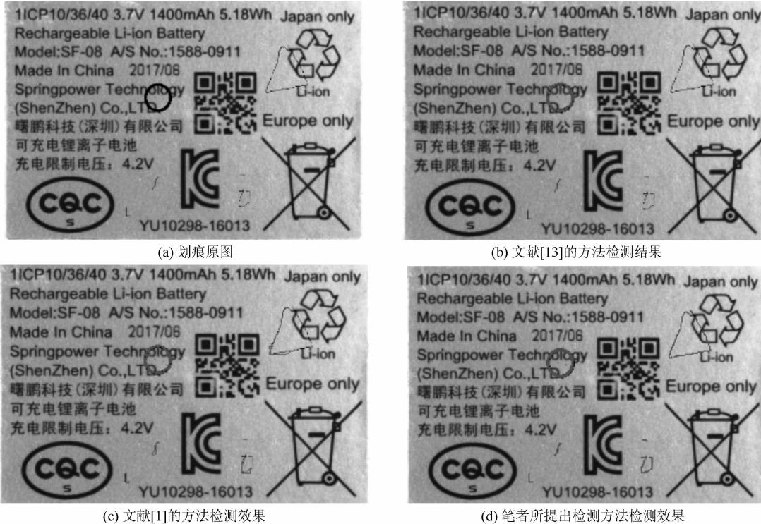
图4 划痕缺陷检测效果对比
