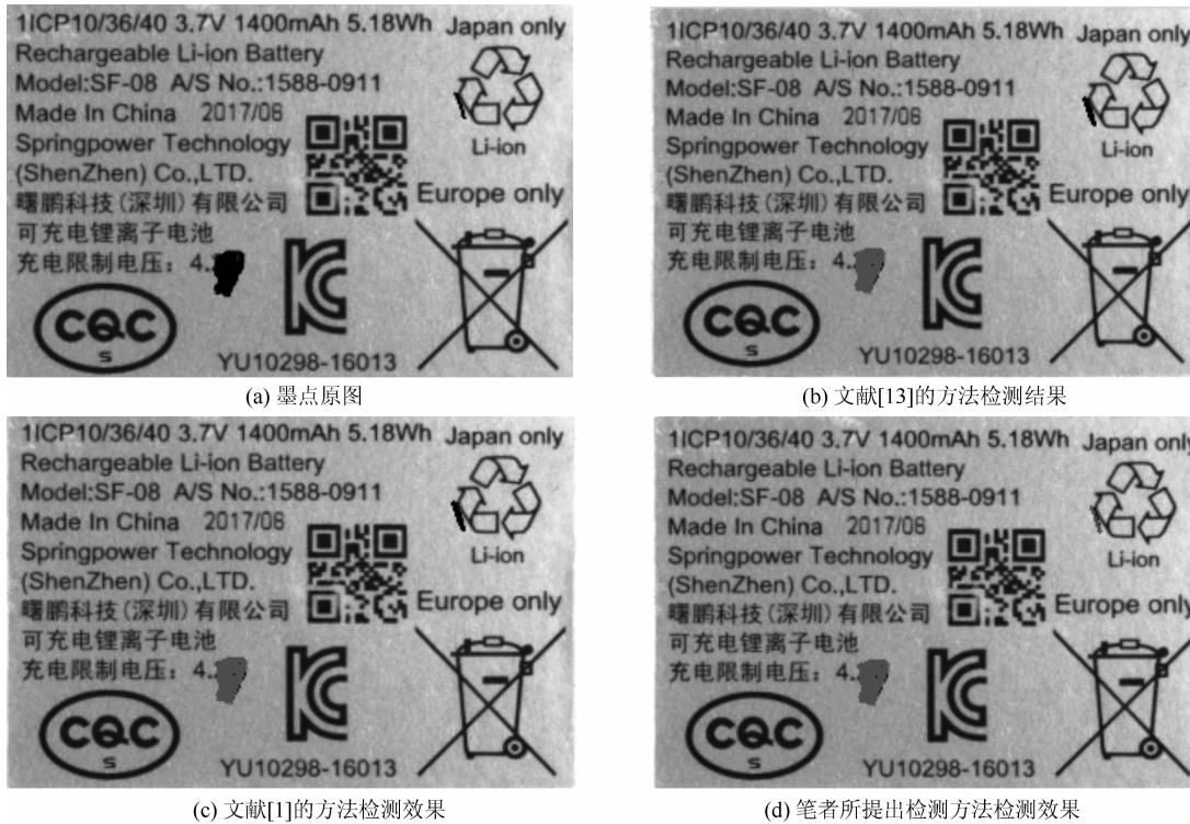
图5 墨点与划痕混合缺陷检测效果对比
