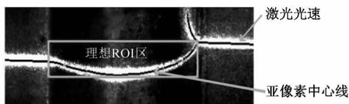
图 1 焊缝图像带有激光光束、亚像素中心线以及理想的 ROI 区域示意图
