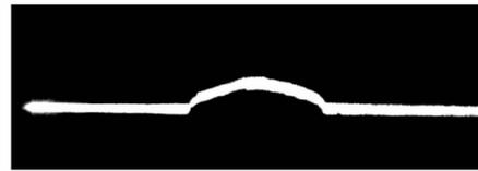
(a) 带有激光光束的焊缝图像
