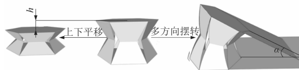
图8 折叠式摆转关节2种变形方式
