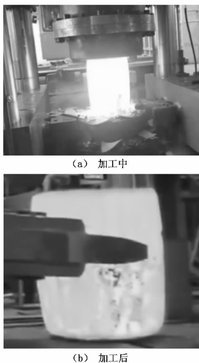
图 16 TC4 钛合金自由锻试件
