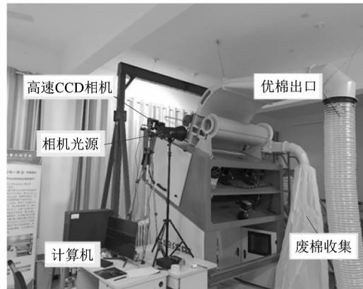
图 3 棉速测量实验平台
