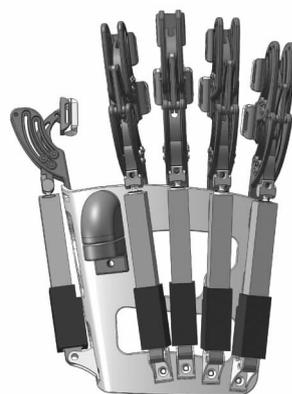
图 9 外骨骼康复机械手样机模型
