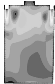
图 4 空仓模型加热仿真速度云图 Figure 4 Velocity image of heating empty heating bin
