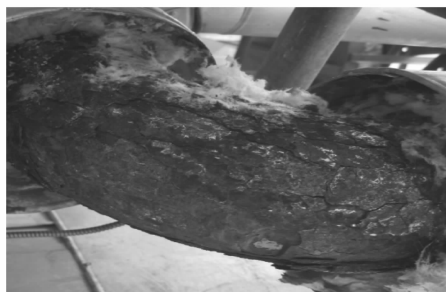
图 1 保温层下腐蚀图示
