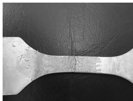
(a) 无涂层镁合金拉伸试样
