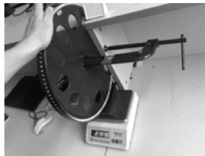
图10 静态载荷约束实验照片
