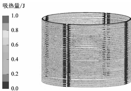
图5 蒸发器内物料吸热量分布云图
