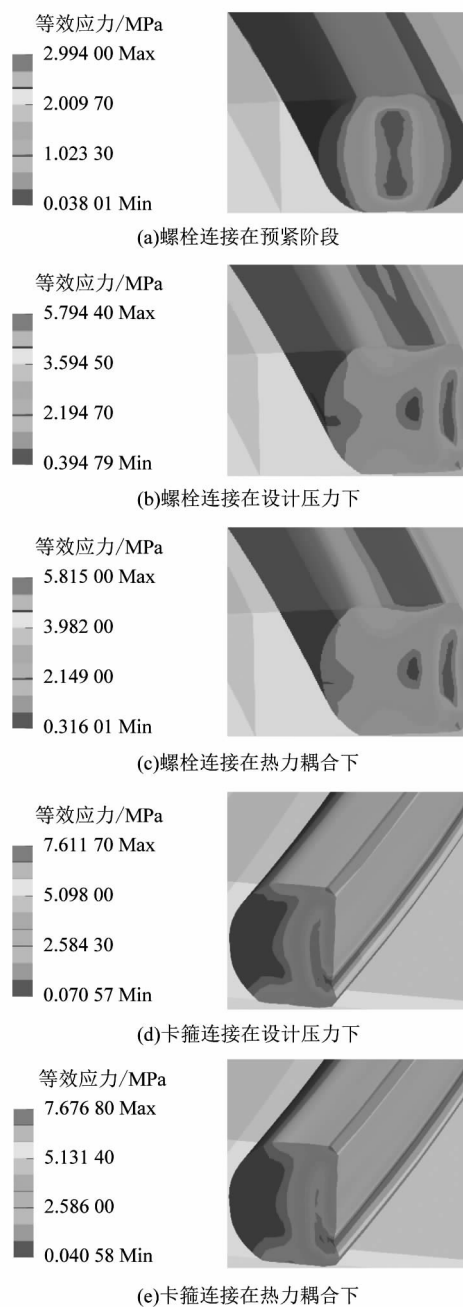
图7 橡胶圈等效应力云图
